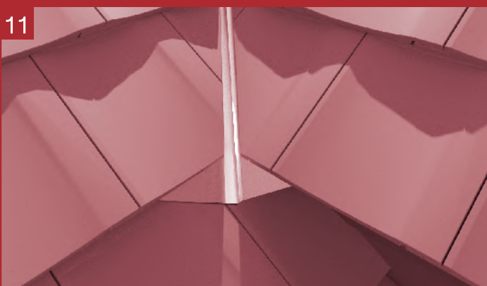
11 กรณีปลายรางน้ำที่อยู่บนผืนหลังคา ให้ปล่อยปลายรางน้ำตะเวีคลุมหลังกระเบื้อง แถวล่างประมาณครึ่งแผ่นกระเบื้อง หรือไม่น้อยกว่า 15 ซม. เคาะปลายรางให้แผ่ราบไปกับหลังกระเบื้องแผ่นที่รองรับเพื่อไม่ให้กระเบื้องกระเด็น ขณะคาะปลายราง ระวังจะทำให้กระเบื้องเกิดการแตกร้าได้
