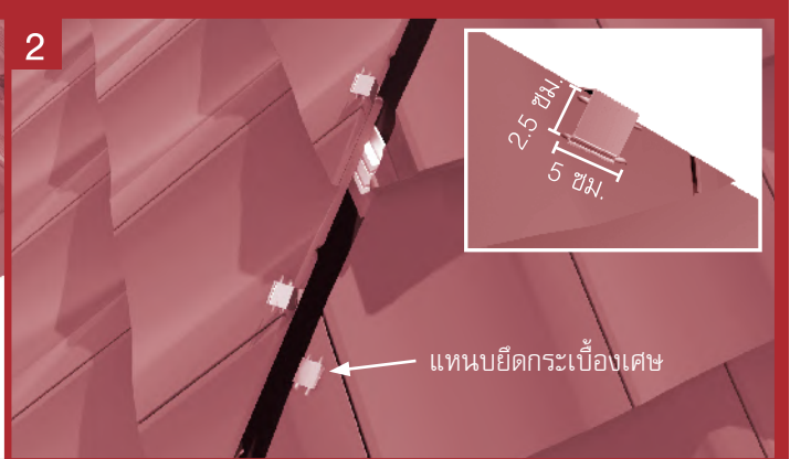
1 ตัดกระเบื้องแนวตะเข้ส้นให้ห่างกันประมาณ 5 ซม. ตรงตลอดแนว โส้เศษกระเบื้องให้ครบ กระเบื้องบริเวณตะเข้ส้นแถวแรกที่เชิงชาย ปลายกระเบื้องส่วนที่ยื่นเลยแนวไม้เชิงชายให้ตัดชิดกันมากที่สุดเป็นมุม 45 องศา เพื่อความสวยงามและป้องกันสัตว์ปีกเข้าได้ครอบปิดปลายตะเข้
